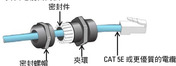
1. 將密封螺母滑到電纜上（不將 RJ45 接頭安裝到末端）。
